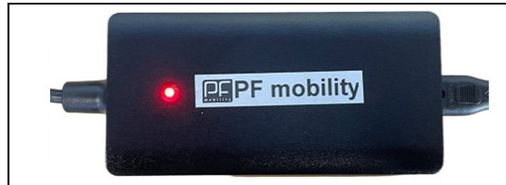
Während des Ladevorgangs leuchtet die LED rot.
