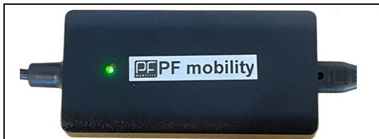
Am Anschluss und am Ende des Ladevorgangs leuchtet die LED grün
