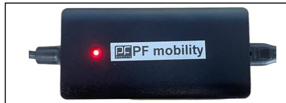
Während des Ladevorgangs leuchtet die LED rot.
