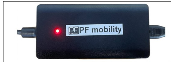
Während des Ladevorgangs leuchtet die LED rot.
